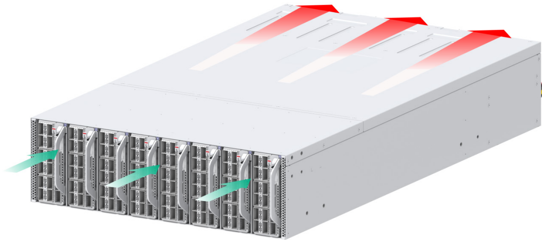
图9-2 端口侧进入电源侧排出散热空气流向示意图
